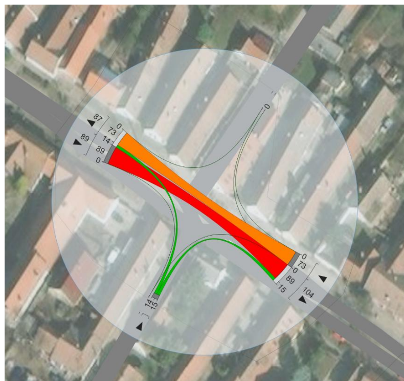
73. ábra. Forgalm nagyság a Kossuth L. út–József A. utca csomópontjában, utána állapot
